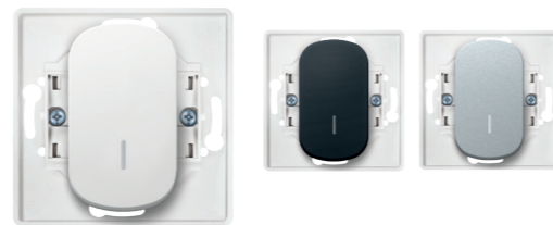
E610IU.x Taster sklopka za zvono sa indikacijom 10A/250V- Bell push-button switch with indication 10A/250V- • Indikacija svetli kada je sklopka isključena • Indication is on when the switch is off
