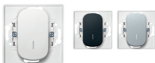
E619U.x Sklopka jednopolna sa indikacijom 16AX/250V- Single-pole switch with indication 16AX/250V- • Indikacija svetli kada je sklopka isključena • Indication is on when the switch is off
