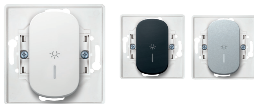
E609IU.x Taster sklopka za svetlo sa indikacijom 10A/250V- Light push-button switch with indication 10A/250V- • Indikacija svetli kada je sklopka isključena • Indication is on when the switch is off
