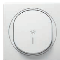
E6091.00 Nyomógomb lámpajellel, jelzőfényes, 10A 250V, komplett Light push-button switch with indication 10AX/250V~ • A jelzőfény bekapcsol, ha a kapcsoló ki van kapcsolva • Indication turns on when the switch is off
