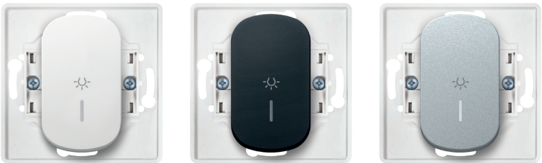
E609IU.x Nyomógomb lámpajellel, jelzőfényes, 10A 250V~, keret nélkül Light push-button switch with indication 10A/250V~ • A jelzőfény bekapcsol, ha a kapcsoló ki van kapcsolva • Indication is on when the switch is off
