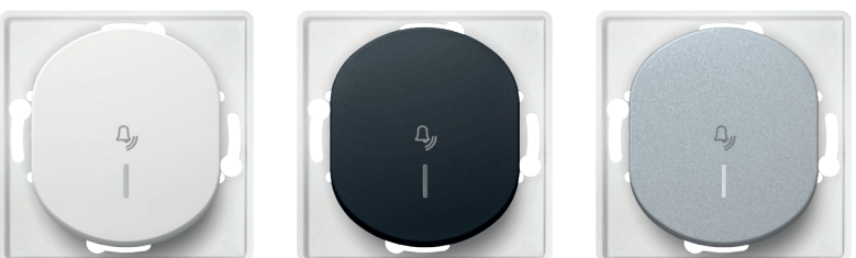
E610I.x Nyomógomb csengőjellel, jelzőfényes, 10A 250V~, keret nélkül Bell push-button switch with indication 10A/250V~ • A jelzőfény bekapcsol, ha a kapcsoló ki van kapcsolva • Indication is on when the switch is off
