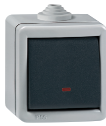
2811.1A Sklopka jednopolna sa indikacijom 10AX/250V- IP55/IK08 Single-pole switch with indication 10AX/250V- IP55/IK08
