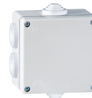
223 Kutija razvodna sa 6 uvoda za na zid 76x76 500V IP55 Wall mounted junction box with 6 cable glands 76x76 500V IP55
