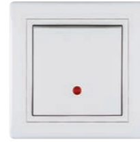
627.xx Alternatív kapcsoló Alternative switch 628.xx Keresztváltó kapcsoló Cross switch Jelzőfényes, 10A 250V~, komplett With indication 10AX/250V~ • A jelzőfény akkor kapcsol be, ha az áramkör nyitva van • Indication turns on when the circuit is open
