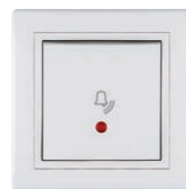
6101.xx Nyomógomb csengőjellel, jelzőfényes, 10A 250V~, komplett Bell push-button switch with indication 10A/250V~ • A jelzőfény bekapcsol, ha a kapcsoló ki van kapcsolva • Indication turns on when the switch is off
