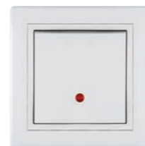
619.xx Egypólusú kapcsoló, jelzőfényes, 16A 250V~, komplett Single-pole switch with indication 16AX/250V~ • A jelzőfény bekapcsol, ha a kapcsoló ki van kapcsolva • Indication turns on when the switch is off
