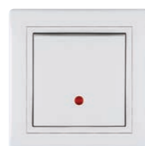
625.xx Egypólusú kapcsoló, jelzőfényes, 10A 250V~, komplett Single-pole switch With indication 10AX/250V~ • A jelzőfény bekapcsol, ha a kapcsoló ki van kapcsolva • Indication turns on when the switch is off
