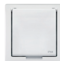
623.xx 2P+F csatlakozó aljzat, 16A 250V~, polikarbonát betéttel, csapófedéllel, IP44, komplett Double-pole socket outlet with cover 16A/250V~ IP44 with polycarbonate insert
