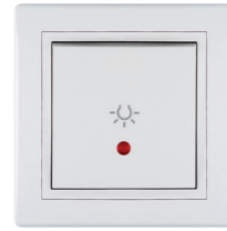
6091.xx Nyomógomb lámpajellel, jelzőfényes, 10A 250V~, komplett Light push-button switch with indication 10A/250V~ • A jelzőfény bekapcsol, ha a kapcsoló ki van kapcsolva • Indication is on when the switch is off
